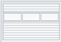
Motív 480 Lamelová výplň s hliníkovým rámom vyplneným mrežovinou Vetrací prierez: 58 % plochy výplne na jeden rám
