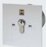
Kľúčový spínač ESU 30 Vyhotovenie pod omietku s 3 kľúčmi Možnosť zvolenia funkcie impulz alebo „otv. / zatv.“, Rozmery krabice: 60 mm (d), 58 mm (h), Rozmery krytu: 90 × 100 mm (š × v), Vybranie v murive: 65 mm (d), 60 mm (h), Druh ochrany: IP 54
