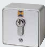
Kľúčový spínač ESA 30 Vyhotovenie na omietku s 3 kľúčmi Možnosť zvolenia funkcie impulz alebo „otv. / zatv.“, Rozmery: 73 × 73 × 50 mm (š × v × h), Druh ochrany: IP 54
