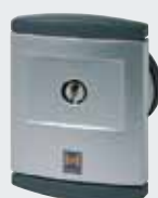
Kľúčový spínač STUP Vyhotovenie pod omietku s 3 kľúčmi Možnosť zvolenia funkcie impulz alebo „otv. / zatv.“, Rozmery krabice: 60 mm (d), 58 mm (h), Rozmery krytu: 80 × 110 mm (š × v), Rozmery v murive: 65 mm (d), 60 mm (h), Druh ochrany: IP 54
