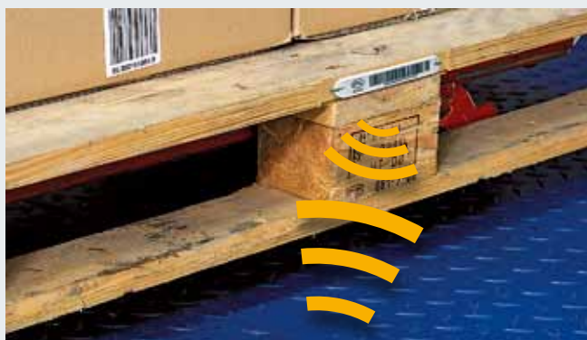
Spoľahlivý prenos údajov na krátku vzdialenosť medzi transpondérom a čítacím zariadením RFID.
